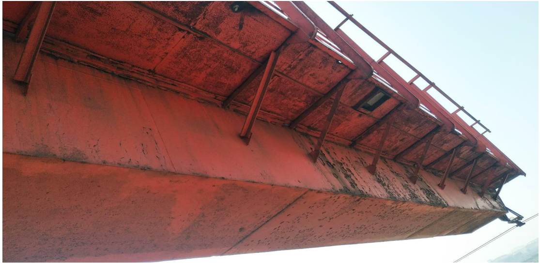
运输处型钢成品组中间库 2#龙门吊车体悬臂现状
